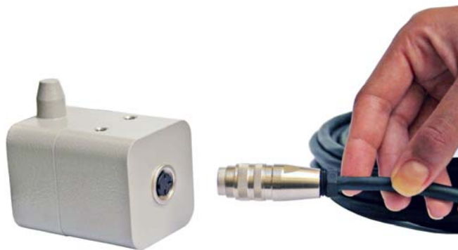
Figura 1.16 – Conectando o cabo ao Sensor de Posição Remoto
