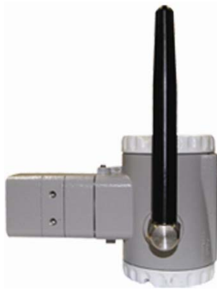
Figura 1.9 – Posição correta da antena com equipamento na horizontal
