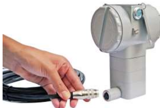
Figura 1.14 – Conectando o cabo ao Transmissor
