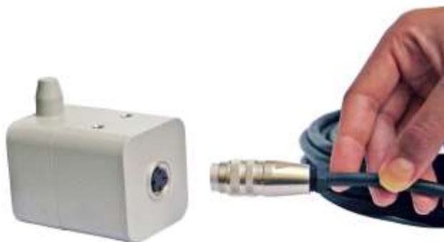
Figura 1.15 – Conectando o cabo ao Sensor de Posição Remoto
