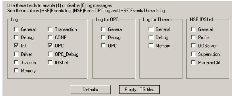
**Figure A.31. System302 ServerManager: Logs Tab**
