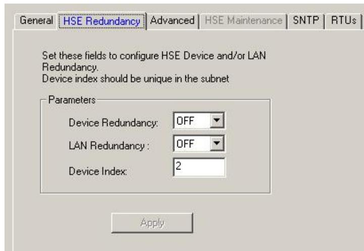
Figure A.11. System302 ServerManager: HSE Redundancy Tab
