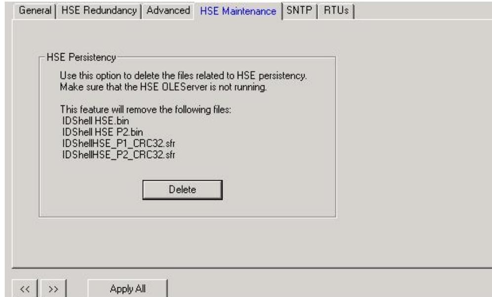
**Figure A.14. System302 ServerManager: HSE Maintenance Tab**
