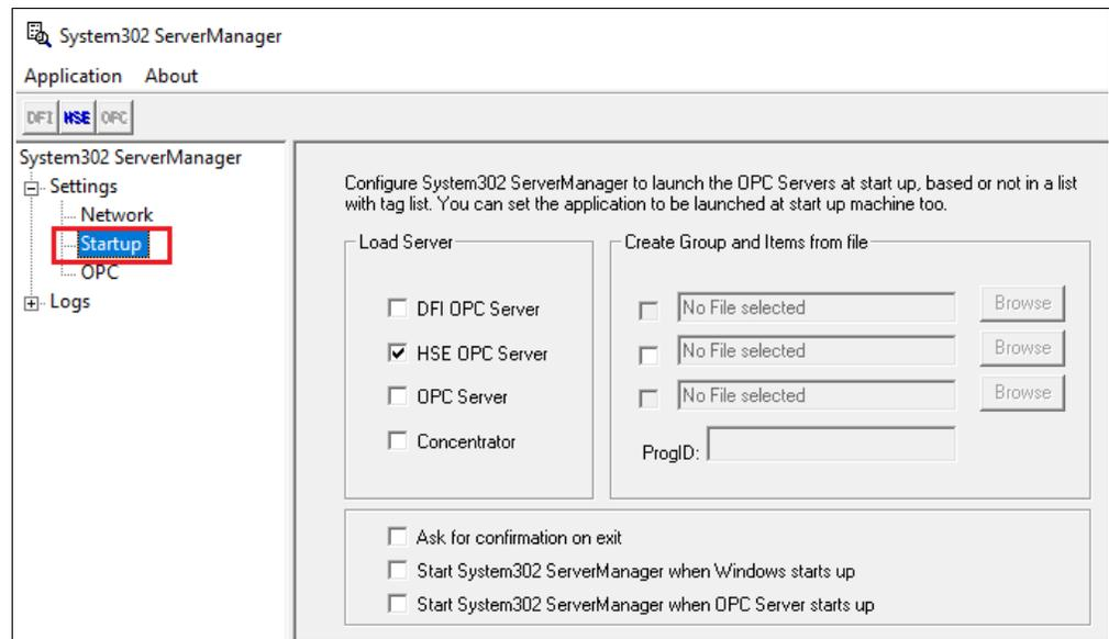
Figure A.19. System302 ServerManager: Startup Tab
