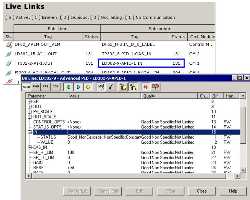
Figure 7.11. Example of a parameter status
