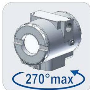
Figura 3.2 – Rotação segura da carcaça
