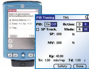
HPC301 Configurador Portátil HART® / plataforma Palm
