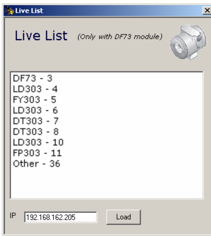
Figura 1 - Live List da Ferramenta Profibus View Configurator
