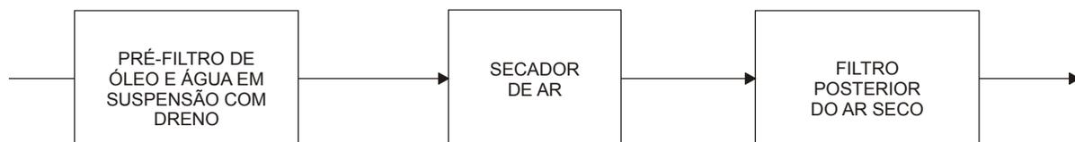
**Figura 1.5 - Sistema de Condicionamento da Qualidade do Ar**
