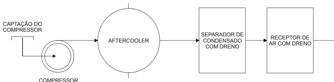
Figura 1.4 - Sistema de Suprimento de Ar
