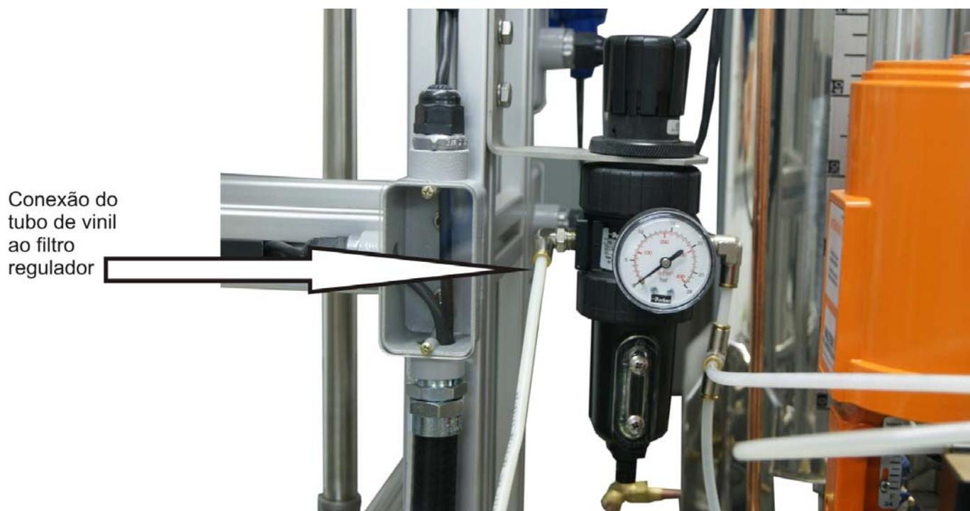
**Figura 1.6 - Conexão do tubo de vinil ao filtro regulador**
