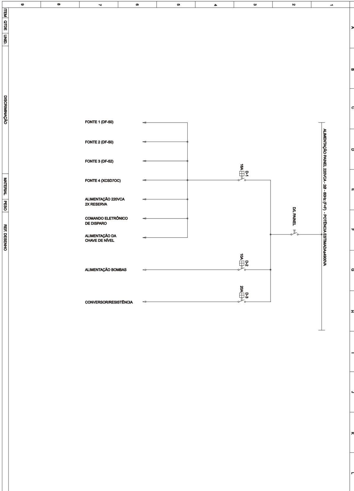
Figura 1.9 – Diagrama de Alimentação – Diagrama Unifilar
