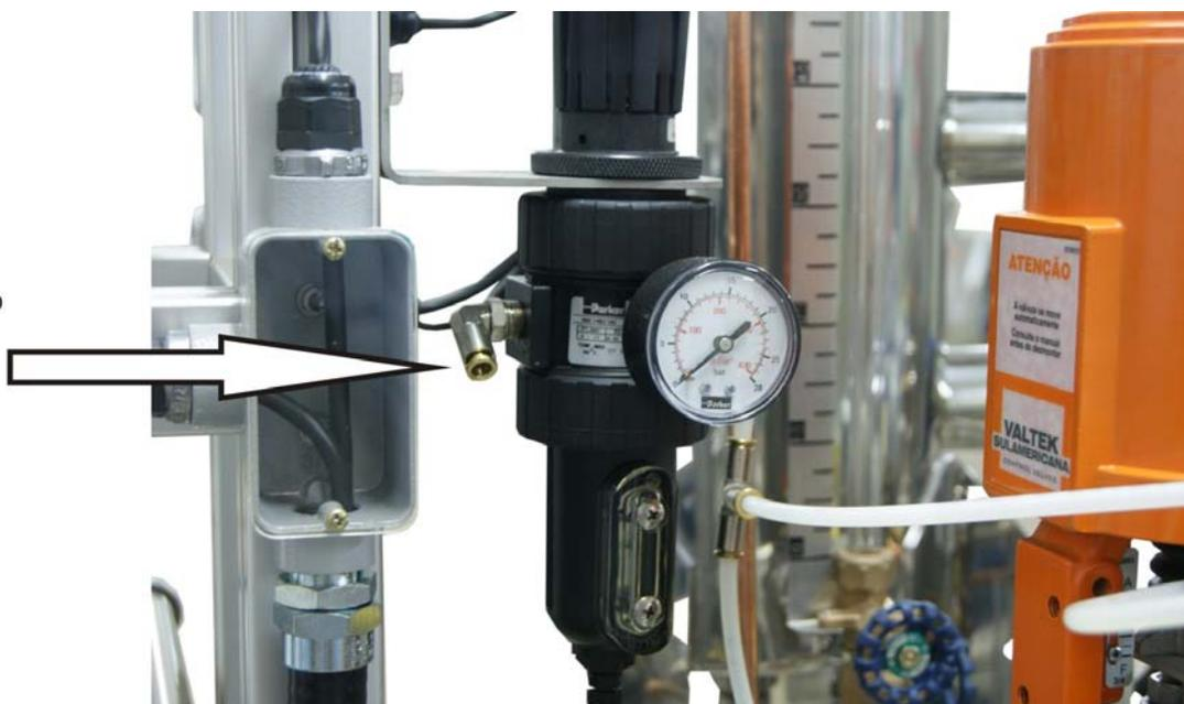
Figura 1.3 - Entrada do tubo de vinil para suprimento de ar no filtro regulador.
