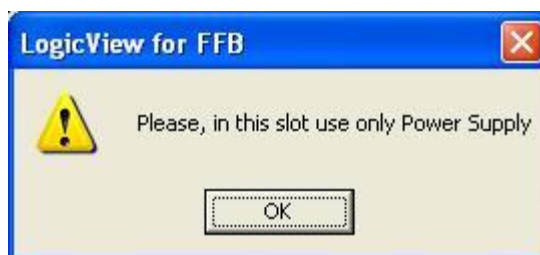
Fig 3. 170 – Erro de inserção de módulos no Rack Z (1)
