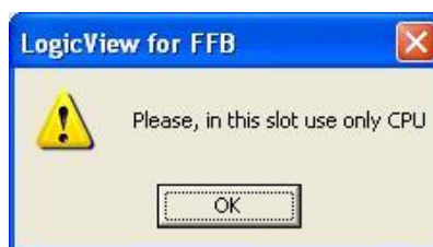
Fig 3. 171 – Erro de inserção de módulos no Rack Z (2)
