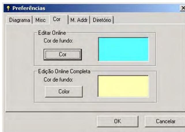
Fig. 3.89 - Alterando a cor de fundo da rede Ladder
