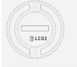
Z: Rotaciona entre as opções: LCD1, LCD2, LCD3 e ESC LCD, para que as variáveis a serem indicadas sejam selecionadas.
