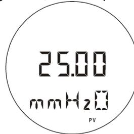
**Figura 2.6 – Modo de Monitoração Típica Mostrando a PV, Neste Caso 25,00 mmH<sub>2</sub>O**
