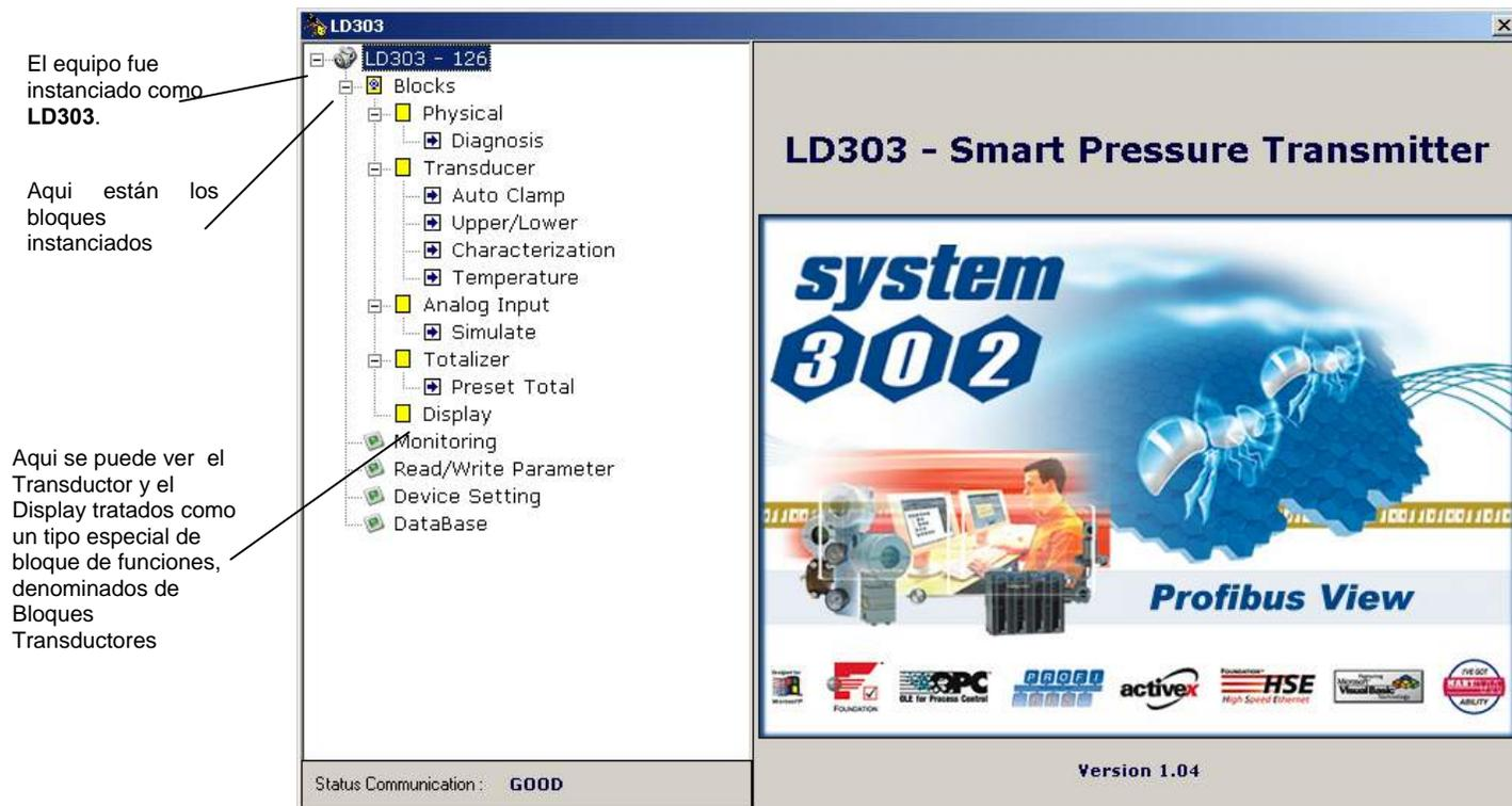
Figura 3.2 - Bloque Transductor y de Función – Profibus View
