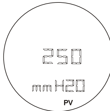
Figura 2.5 – Modo de Monitoreo típico que muestra la PV (variable primaria), en este caso 25.00 mmH 2 O
