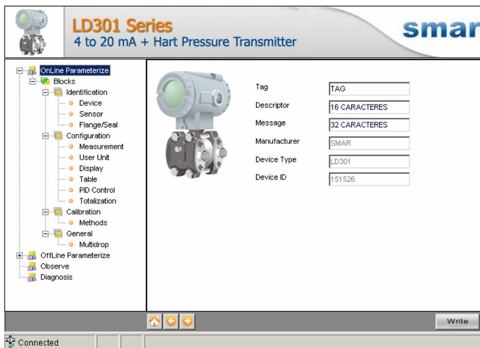
Figura 3 – Tela da Função "Online Parameterize" do LD301DTM
