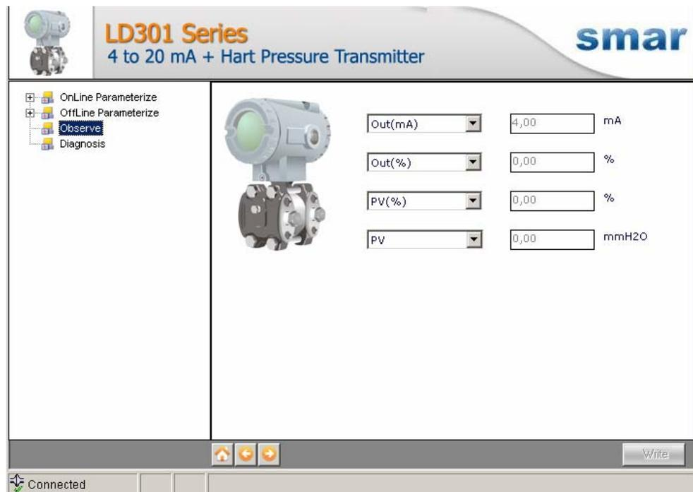
Figura 5 – Tela da Função “Observe” do LD301DTM
