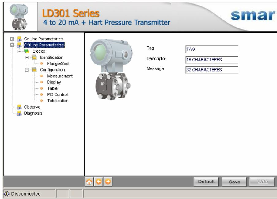
Figura 4 – Tela da Função “Offline Parameterize” do LD301DTM
