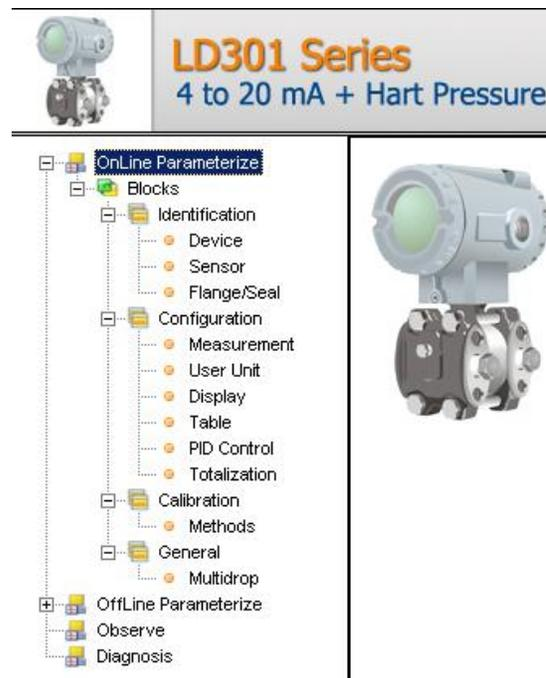
**Figura 2 – Tela da Árvore de Navegação do LD301DTM**
