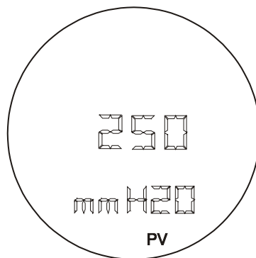
Figura 2.5 – Visor en el Monitoreo típico que muestra la PV (variable primaria), en este caso 250 mmH 2 O
