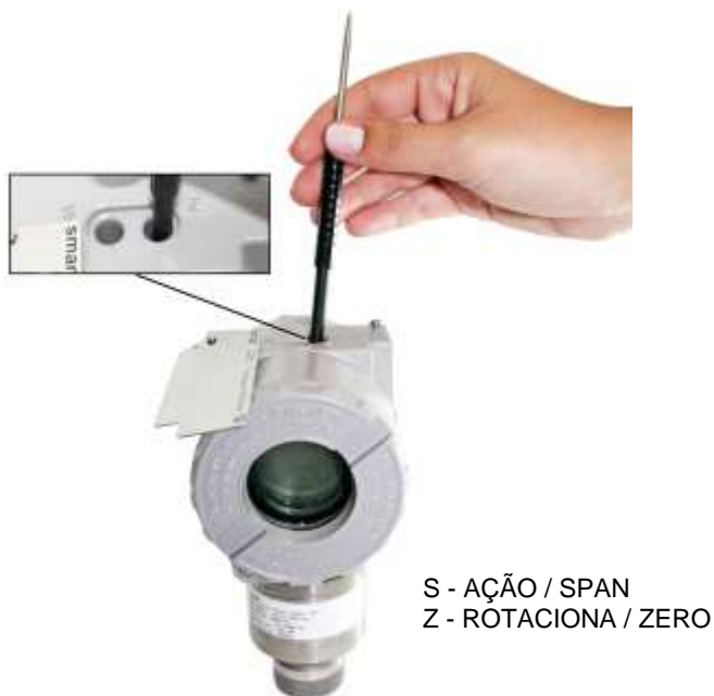
Figura 4.1 – Ajuste Local de Zero e Span e Chaves de Ajuste local
