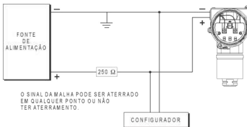
Figura 1.7 – Diagrama de Ligação do LD291 operando como Transmissor
