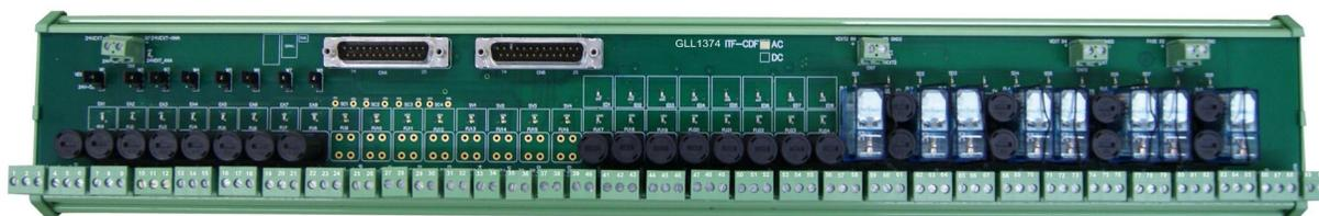
Figura 32– Interface para Painel ITF-CD-A (Saídas Digitais Com Fusível)
