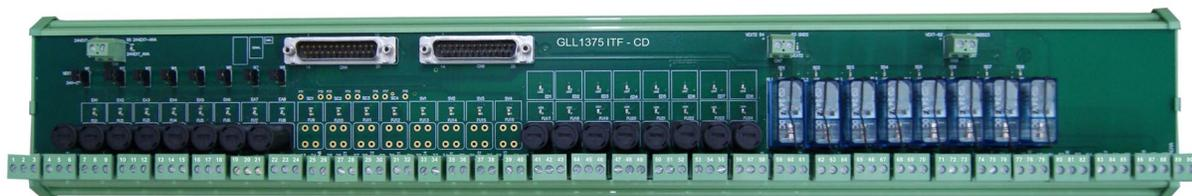
Figura 31– Interface para Painel ITF-CD-0 (Saídas Digitais Sem Fusível)
