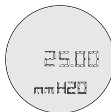
Figura 2.3 – Modo de Monitoração Típico mostrando no indicador o valor de 25,00 mmH 2 O
