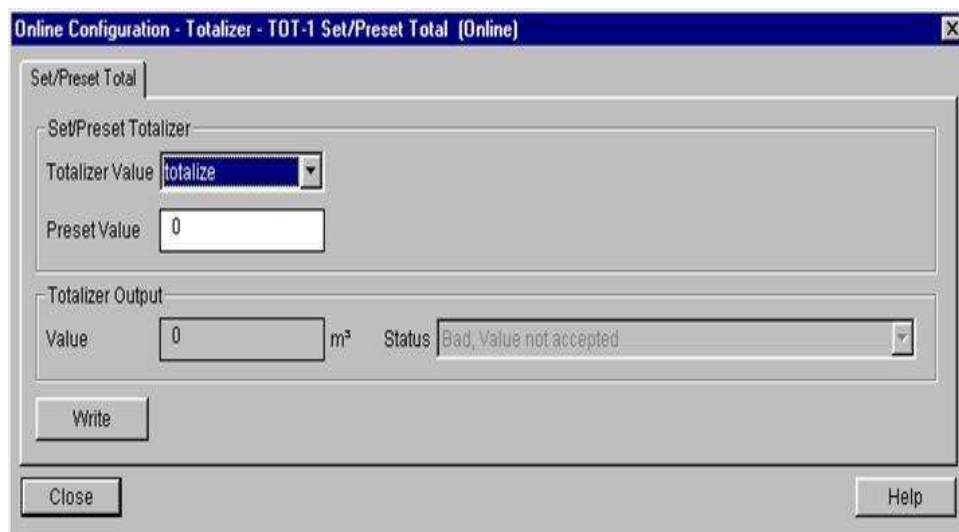
Figura 3.20 - Configuração Set/Preset para Bloco Totalizador - Simatic PDM
