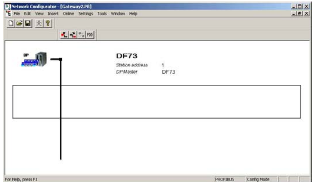
Figura 2.15 – Posicionando o Equipamento Escravo na Rede Profibus
