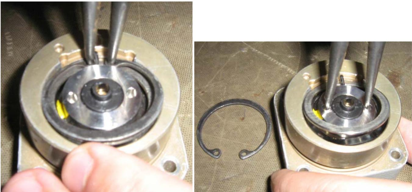
**Figura 15 - Retirada do Capacete que contém o piezo**
