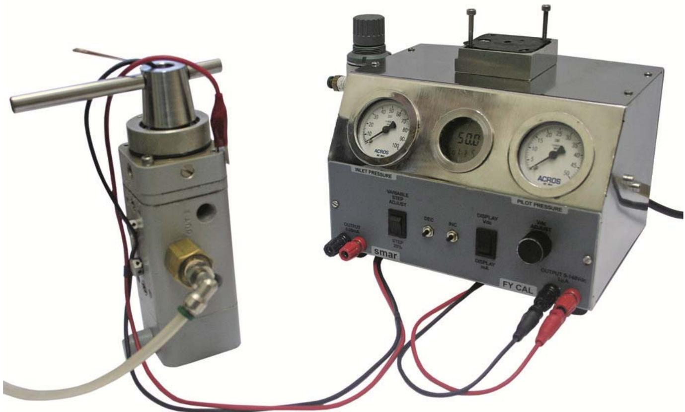
**Figura 11 – Base do Piezo montada para utilizar a Fonte de Tensão do FYCAL**
