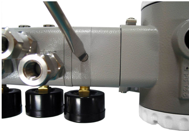
Figura 6.15 – Retirando Parafuso da Restrição
