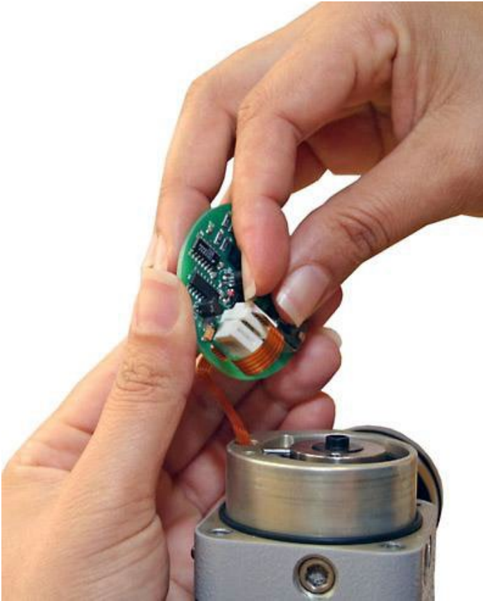
Figura 6.11 – Puxando, com a unha, a trava que prende o flat cable na placa analógica
