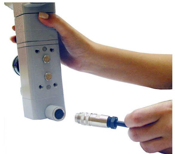
Figura 1.24 – Conectando o cabo ao Posicionador
