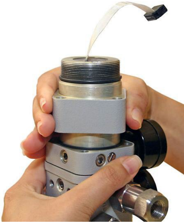
Figura 6.7 – Soltando a tampa de ligação da base montada
