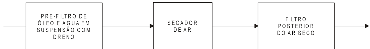
Figura 1.20 - Sistema de Condicionamento da Qualidade do Ar
