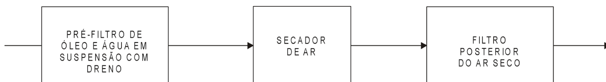
Figura 1.12 - Sistema de Condicionamento da Qualidade do Ar
