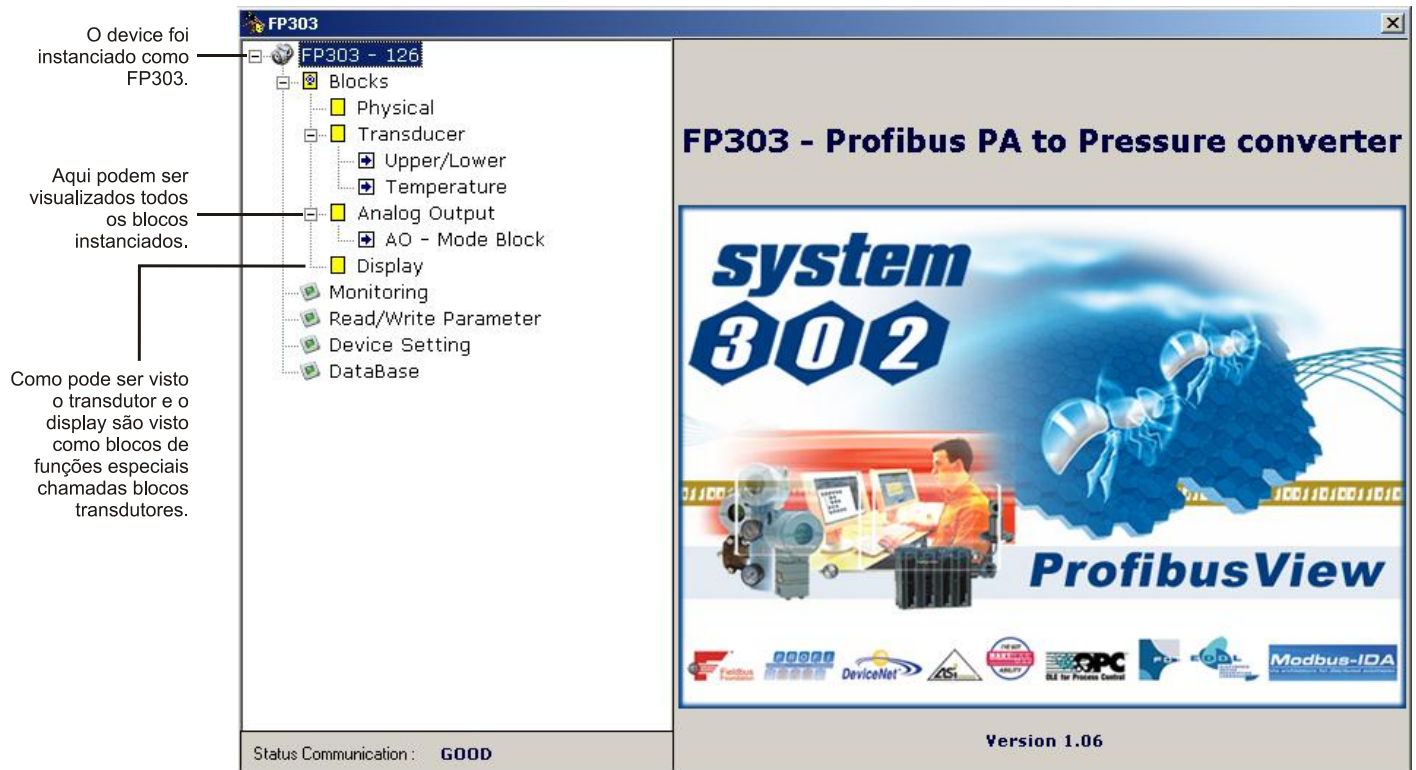
Figura 3.2 - Blocos de Função e Blocos Transdutores – ProfibusView
