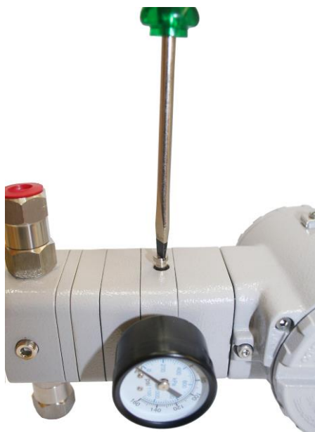
Figura 4.3 – Removendo a restrição do conversor
