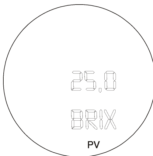
Figura 2.4 - Modo de Monitoração Típico mostrando no Indicador a PV, neste caso indicando 25,0 BRX
