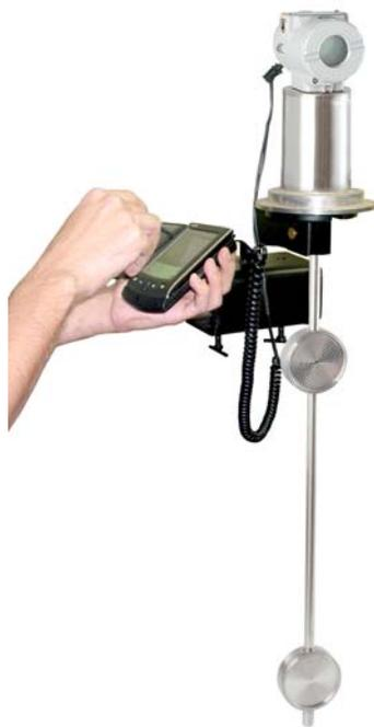
**Figura 3.3 – Auto calibración en la atmosfera**
