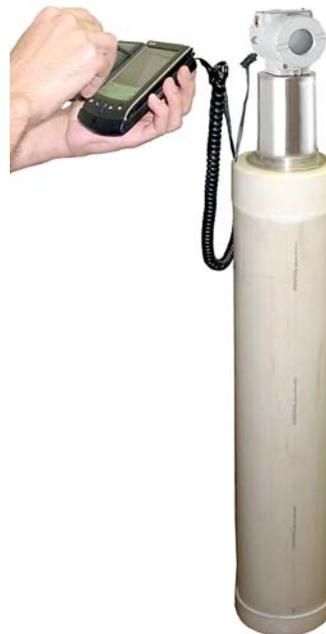
**Figura 3.4 – Auto calibración en agua**
