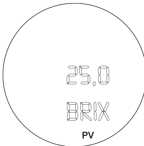
Figura 2.4 – Modo de Monitoração Típico mostrando no Indicador a PV, neste caso 25,0 BRIX
