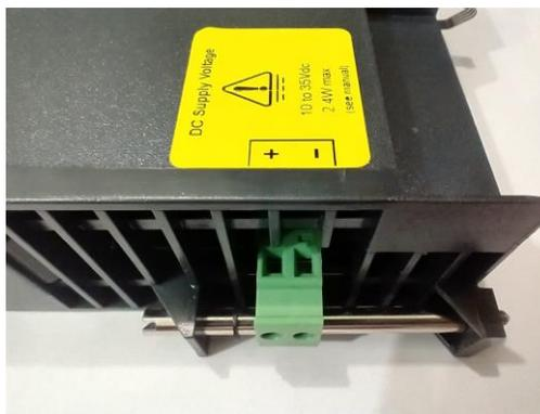
Figura 3 – DF125 - conector para fonte de alimentação
