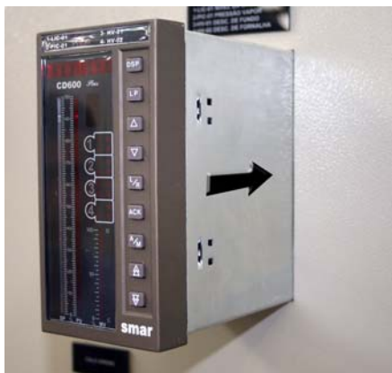
Figura 1 – CD600 PLUS parcialmente inserido na abertura
