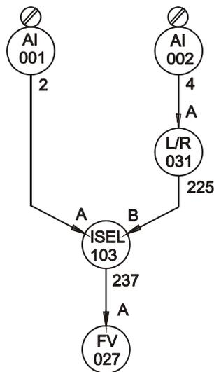
**Figura 4.29.1 - Loop de Controle com 2 Atuadores de Setpoint**
