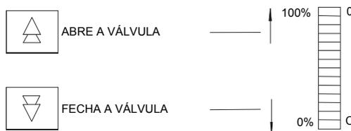
Se o atuador da válvula é "ar-para-abrir", MV = 100% deve ser equivalente a 20 mA. Válvulas do tipo "ar-para-fechar" terão 100% equivalente a 4 mA. Isto pode ser selecionado na **Função 02 - Saída em Corrente**.
