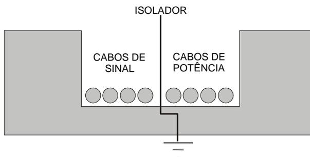
**Figura 9.7 - Arranjo dos Cabos na Bandeja**
