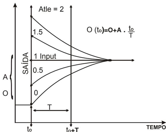
**Figura 4.15.2 - Resposta da função Lead-Lag a um degrau**
