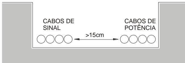
**Figura 9.9 - Arranjo dos Cabos na Bandeja**
