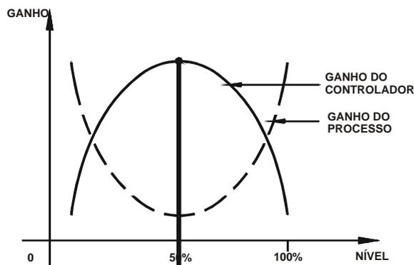
**Figura 4.9.6 - Ganho do Processo e do Controlador**
