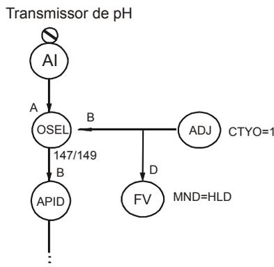
**Figura 4.30.1 - Configuração para Seletor L/R com Setpoint Tracking**
