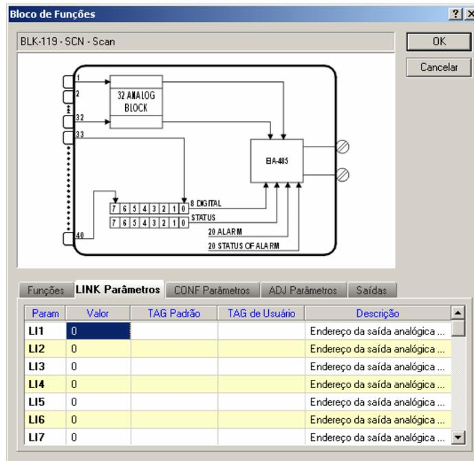
Figura 14.8 – Alterando Valores de Parâmetros de Bloco
