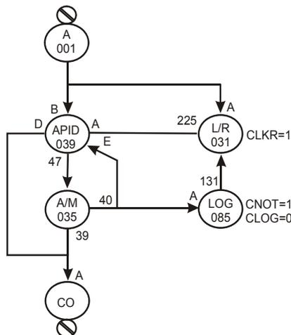
**Figura 4.7.1 - Configuração para Seletor L/R com Setpoint Tracking**
