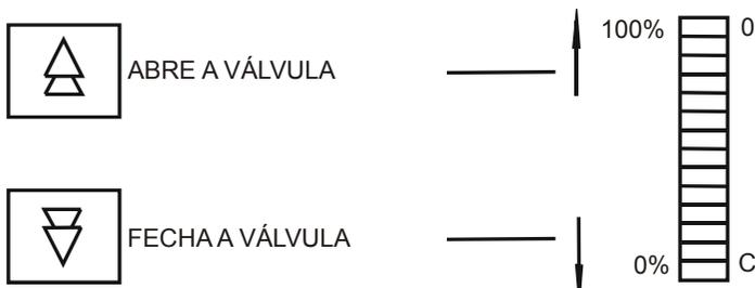
Se o atuador da válvula é "ar-para-abrir", **MV** = 100% deve ser equivalente a 20 mA. Válvulas do tipo "ar-para-fechar" terão 100% equivalente a 4 mA. Isto pode ser selecionado na **Função 02 - Saída em Corrente**.
