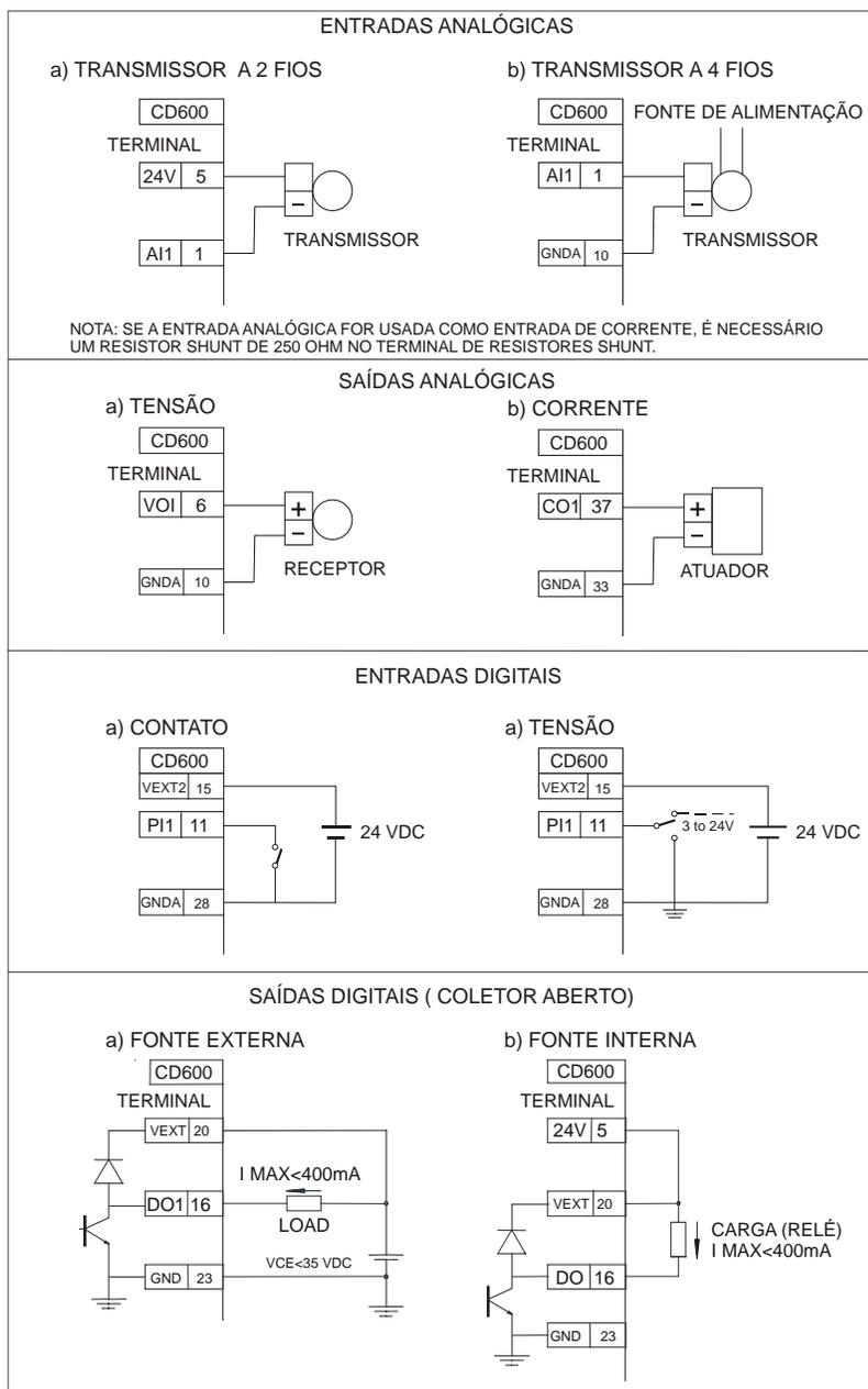
Figura 8.3 - Diagrama de Cabeamento para Entradas e Saídas
