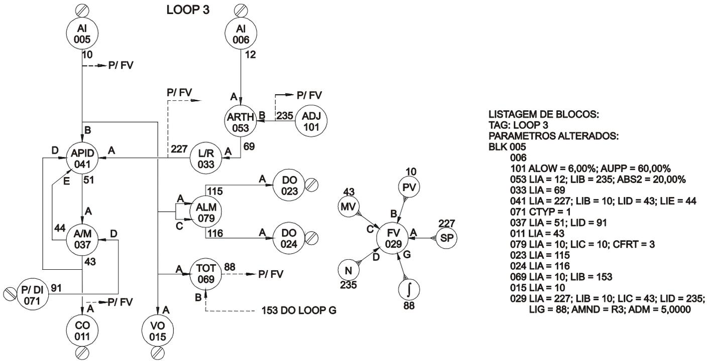
Figura 5.4 – Listagem de Blocos da Configuração “4 LOOPS” – LOOP 3
