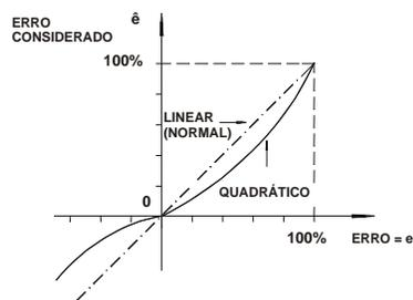
Figura 4.9.2 - Erro Quadrático x Erro Normal
