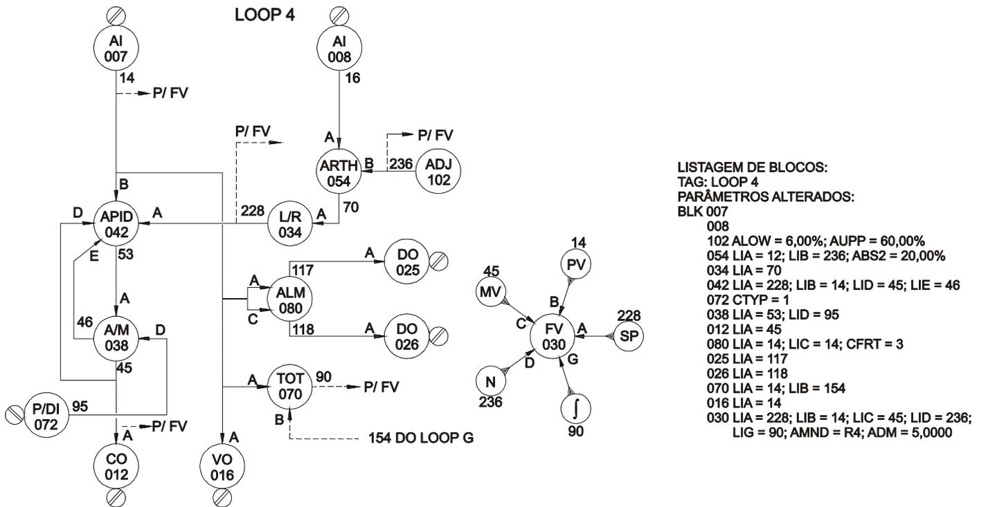
Figura 5.5 - Listagem de Blocos da Configuração "4 LOOPS" - LOOP 4
