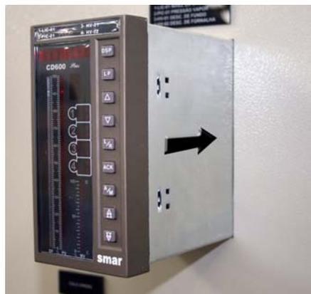
**Figura 1 – CD600 PLUS parcialmente inserido na abertura**
