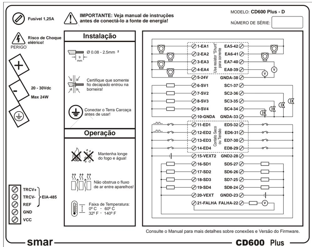
Figura 8.5. Etiqueta Lateral com Diagrama da Borneira DC
