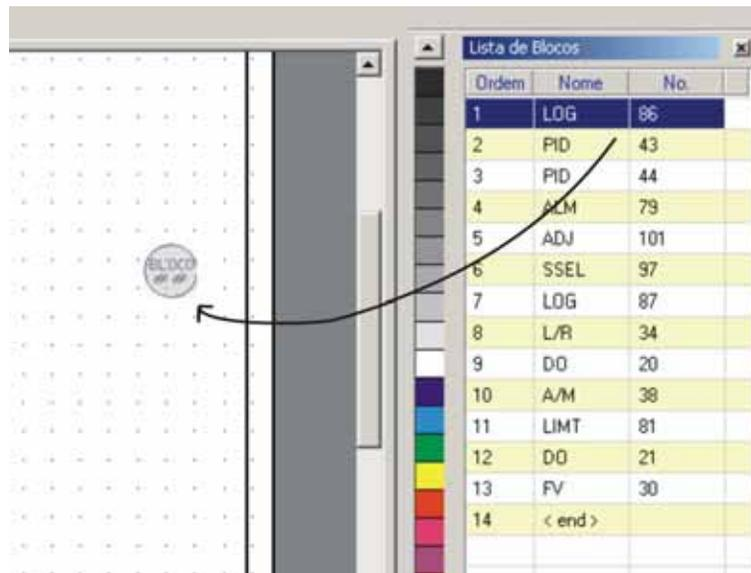
**Figura 14.4 - Arrastando um Bloco na Área de Desenho**
