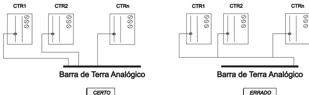
Figura 9.3 - Ligação do Terra Analógico (Bornes: 10,33,38)
