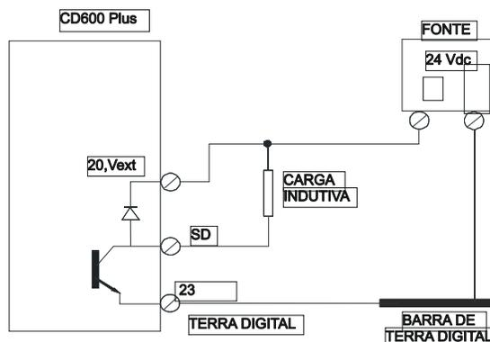
Figura 9.6 - Ligação de Cargas Indutivas nas Saídas Digitais
