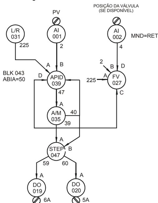
**Figura 4.11.1 - Configuração Básica para um Controle Step**
