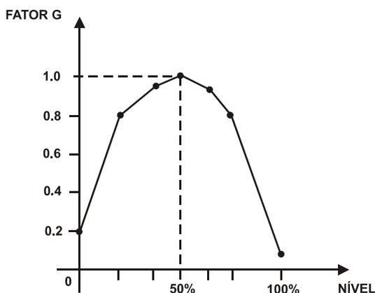
**Fig 4.9.7 - Curva de Ganho em Função de PV**
