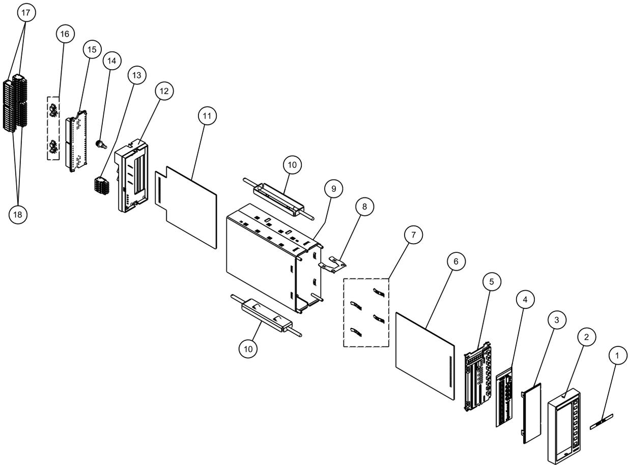
Figura 8.7 – Vista Explodida Controlador Digital CD600 Plus
