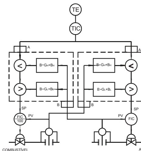
**Figura 4.23.1 - Controle de Combustível com Duplo Limite Cruzado**
