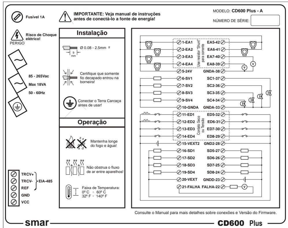
Figura 8.4. Etiqueta Lateral com Diagrama da Borneira AC
