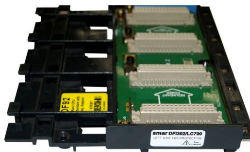
Figura 3.5 – Protetor lateral esquerdo instalado no rack
