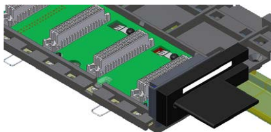
Figura 3. 10 – Protetor de flat cables instalado
