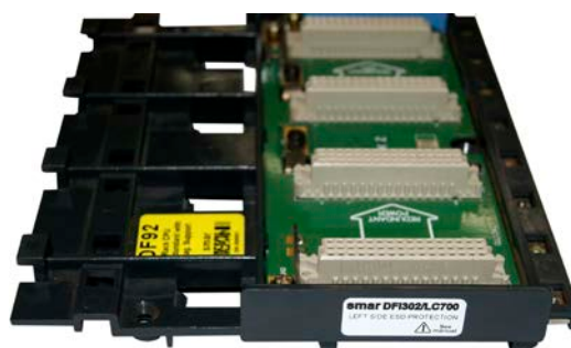
Figura 3.5 – Protetor lateral esquerdo instalado no rack
