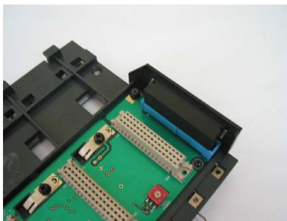
Figura 3. 11 – Terminador DF2 instalado
