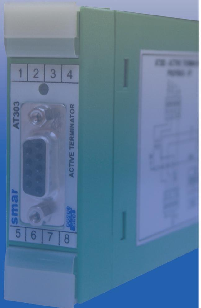
O AT303 é um terminador ativo que foi desenvolvido para aumentar a disponibilidade da rede PROFIBUS-DP e facilitar o acesso a qualquer nó no barramento PROFIBUS-DP sem colocar a rede em situação de intermitência. Desta forma, qualquer escravo da rede pode ser desligado, removido ou substituído sem comprometer a comunicação e ainda em especial, na situação em que os terminadores ficam habilitados nos escravos nos extremos da rede.
