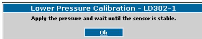
**Figura 7. Estabilizando a Pressão**
