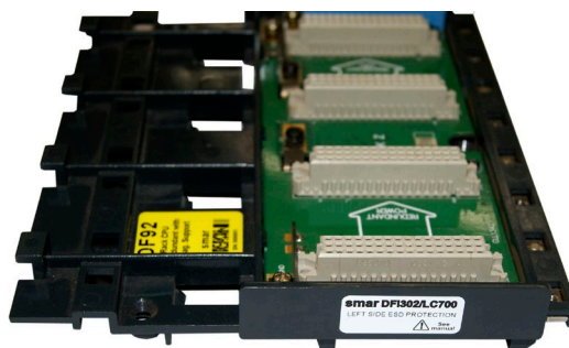
Figura 3. 5 – Protetor lateral esquerdo instalado no rack
