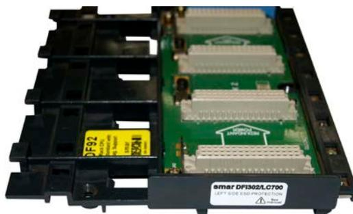
**Figura 3.5 – Protetor lateral esquerdo instalado no rack**
