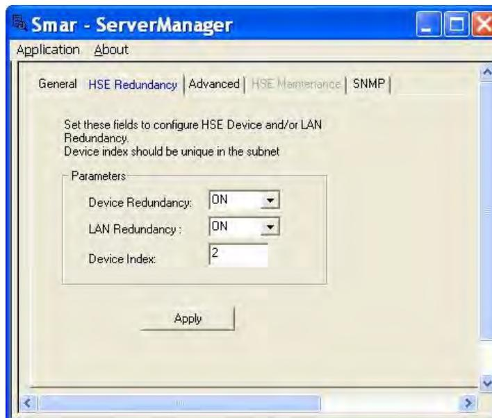
**Figura 14. 4 – Server Manager: Aba HSE Redundancy**
