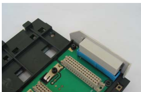
Figura 3. 11 – Terminador DF2 instalado
