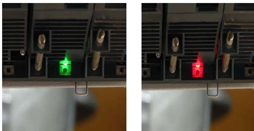
Figura 3. 21 – LEDs para diagnóstico no rack DF93
