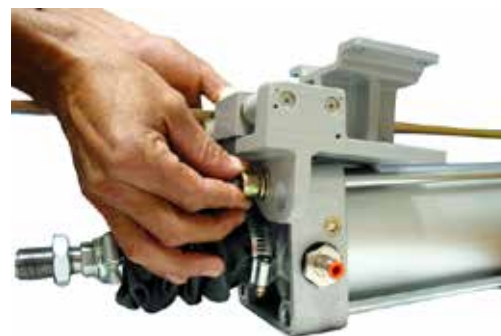
Figura 4.8 – Soltando os Parafusos Allen
