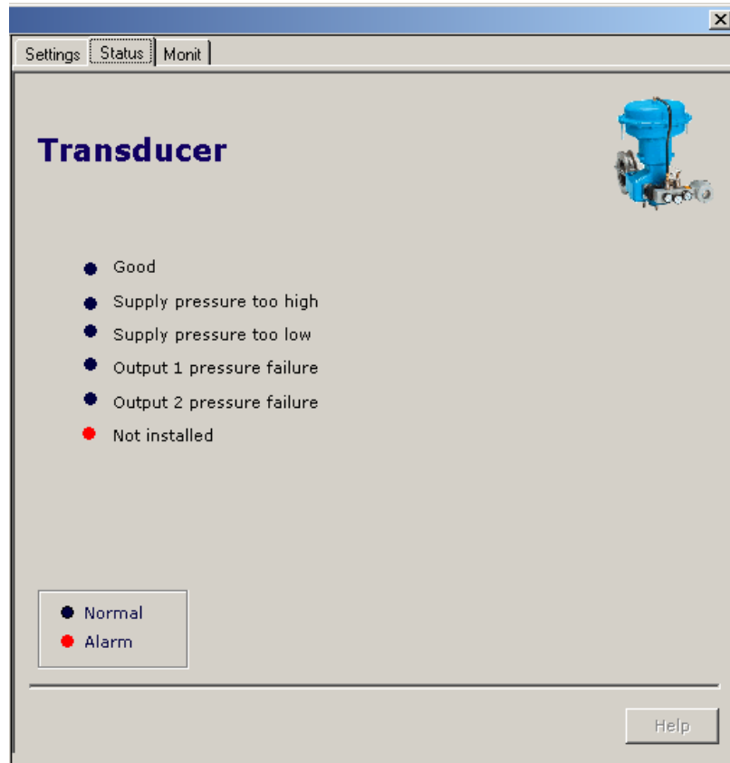
Figura 3.43 - Verificando a Instalação dos Sensores de Pressão do FY303 - ProfibusView
