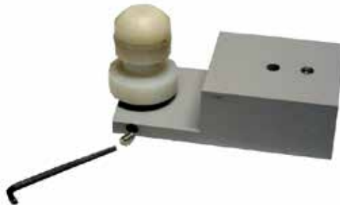
Figura 4.13 – Soltar o Rolete Móvel da Base Móvel
