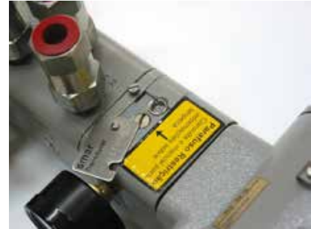
Figura 4.22 – Placa de Proteção da Restrição retirada
