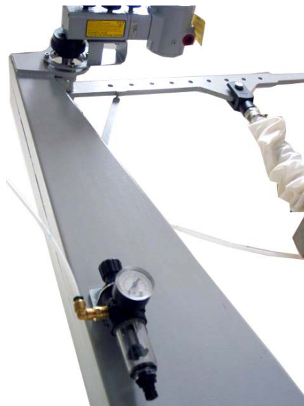
Figura 1.30 - Instalação do Filtro de Ar
