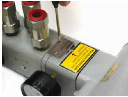
Figura 4.21 – Removendo a placa que protege a Restrição
