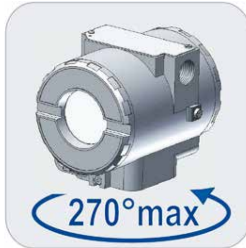
Figura 4.19 – Rotação do Transdutor
