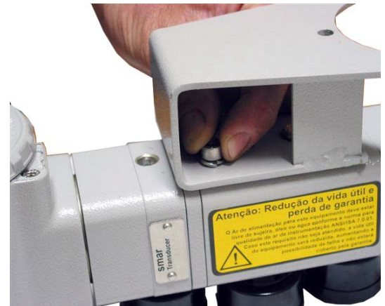
Figura 1.21 - Montagem do Suporte no Posicionador
