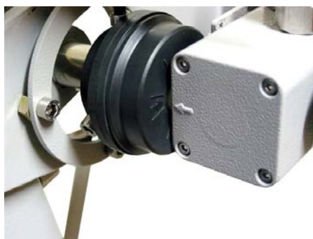
Figura 1.26 - Detalhe da Fixação dos Parafusos do Ímã Rotativo
