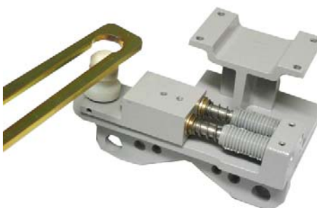
Figura 5.10 – Desmontagem da Régua
