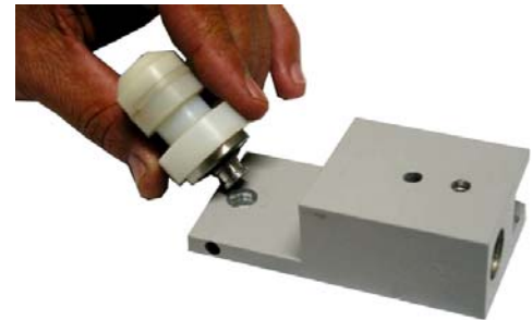
Figura 5.14 – Desmontagem do Rolete Móvel
