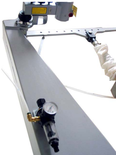
Figura 1.30 - Instalação do Filtro de Ar
