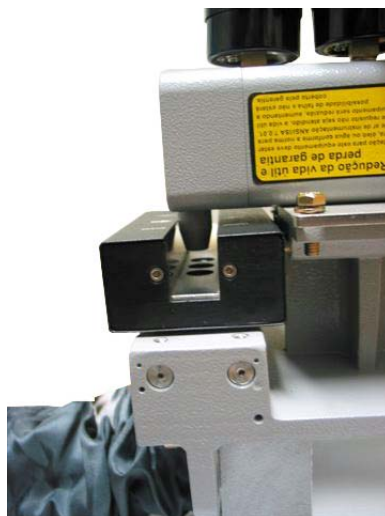
Figura 1.13 - Alinhamento da Posição do Ímã com Sensor Hall
