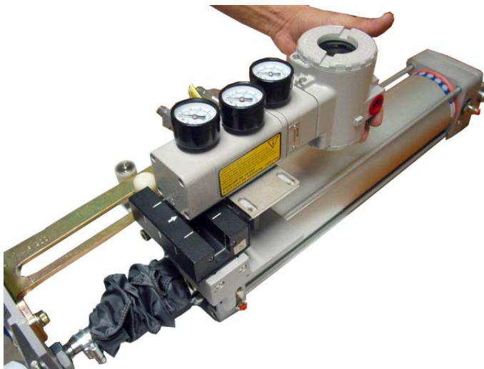
Figura 1.9 - Montagem do Posicionador no Cilindro
