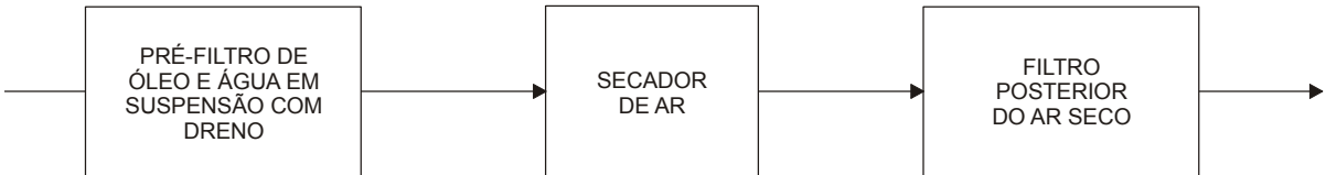
Figura 1.42 - Sistema de Condicionamento da Qualidade do Ar
