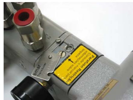
Figura 5.22 – Placa de Proteção da Restrição retirada
