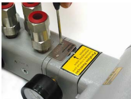
Figura 5.21 – Removendo a placa que protege a Restrição
