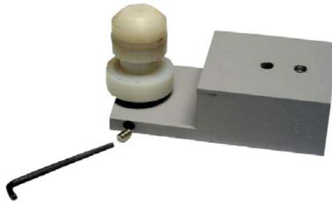
Figura 5.13 – Soltar o Rolete Móvel da Base Móvel
