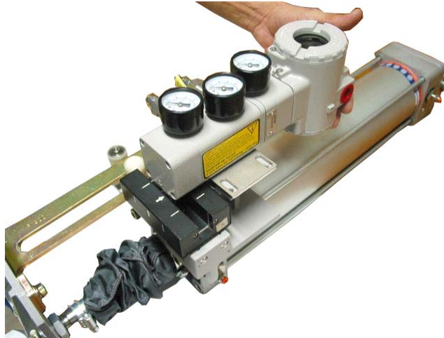
Figura 5.2 – Desmontagem do Posicionador do ACP do Cilindro
