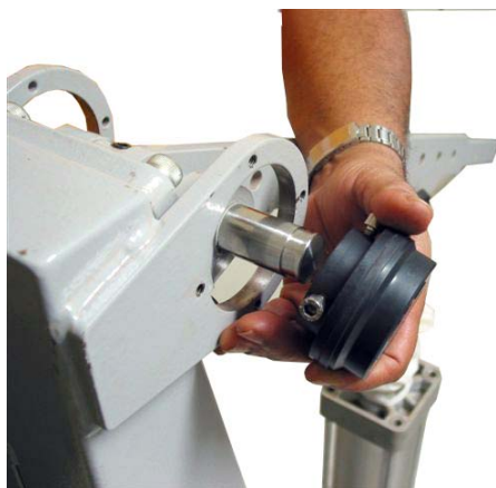
Figura 1.18 - Colocação do Ímã no Eixo
