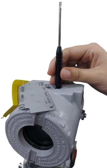
Figura 4.2 - Ajuste Local de Zero e Span e Chave de Ajuste local
