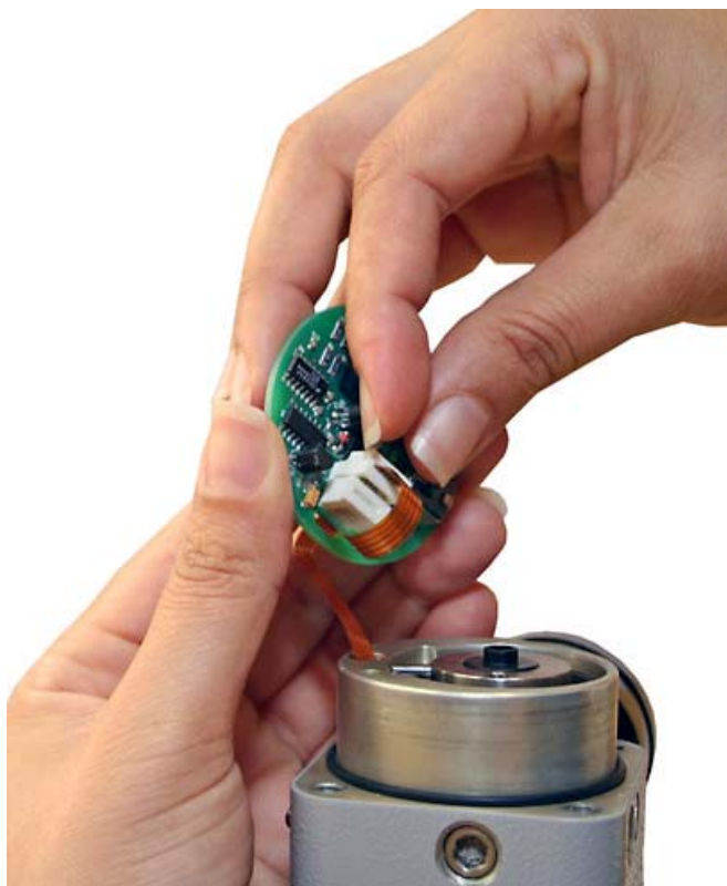
Figura 6.11 – Jale con la uña, el seguro que sostiene el cable plano en la placa analógica
