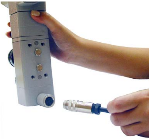
Figura 1.24 – Conectando el cable al Posicionador
