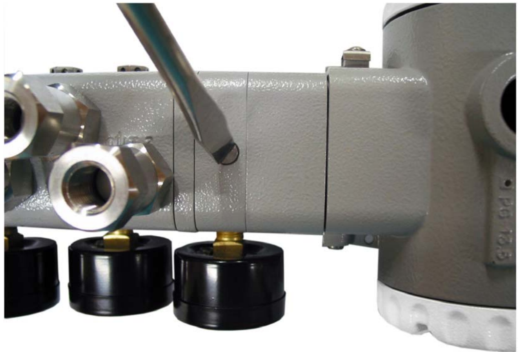
Figura 6.15 – Retirando el Tornillo de la Restricción
