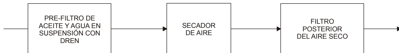
Figura 1.20 – Sistema de Acondicionamiento de la Calidad del Aire
