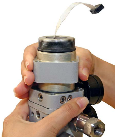
Figura 6.7 – Soltando la tapa de conexión de la base ensamblada.
