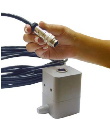
Figura 1.23 – Conectando el cable al Sensor Hall Remoto
