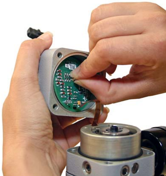
Figura 6.9 – Retirando la placa analógica de la tapa de conexión
