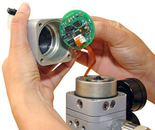
Figura 6.10 – Placa analógica desacoplada de la base ensamblada.
