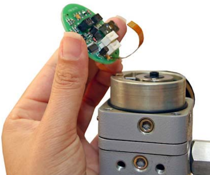
Figura 6.12 – Cable plano suelto del conector
