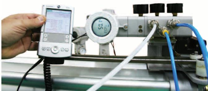
Configuração local ou remota com terminal HPC401
