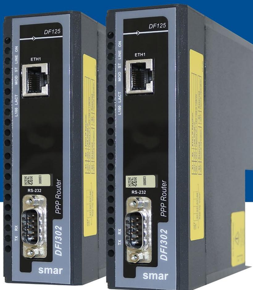
O **DF125** é um elemento chave para conectar a infraestrutura RTU Smar com o sistema de telecomunicações usados em plantas extensas, possibilitando o encapsulamento PPP (Protocolo Ponto-a-Ponto) serial de todos os protocolos utilizados pela RTU Smar.
