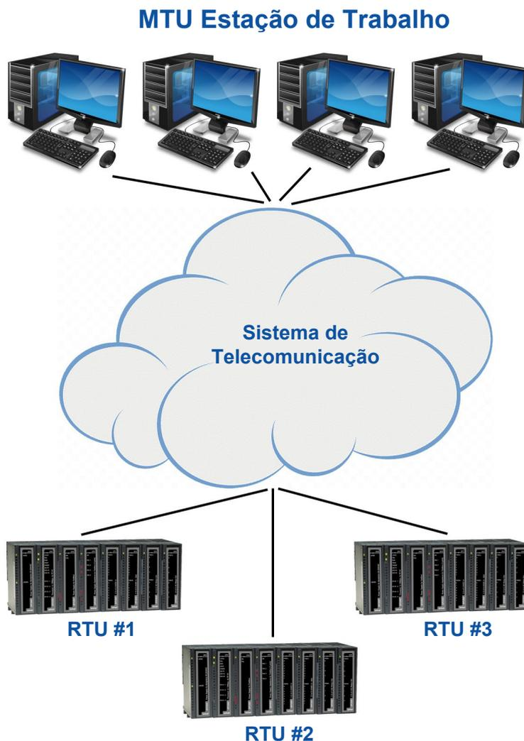
**Visão geral do sistema utilizando MTU, RTU e DF125**
