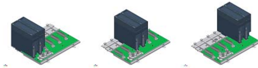
Figura 29 - Rack mestre com (a) Fontes de Alimentação Redundantes (b) Controladores Redundantes (c) Scanners Redundantes Mestres
