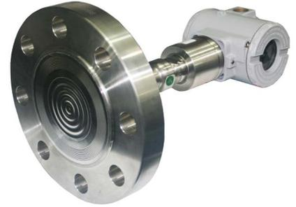
Los modelos LD290I son Transmisores de Presión con Sonda Extendida para medición de nivel, volumen y masa en tanques no presurizados. Una sonda con longitud predefinida y un sensor en sus extremidades que se encuentran sumergidos en el fluido del proceso que provee una presión diferencial proporcional al nivel del líquido. Están disponibles varias opciones de conexiones al proceso.
